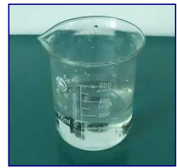
盐雾测试完成后将样品取出， 放入量杯中，用清水清洗样品。
